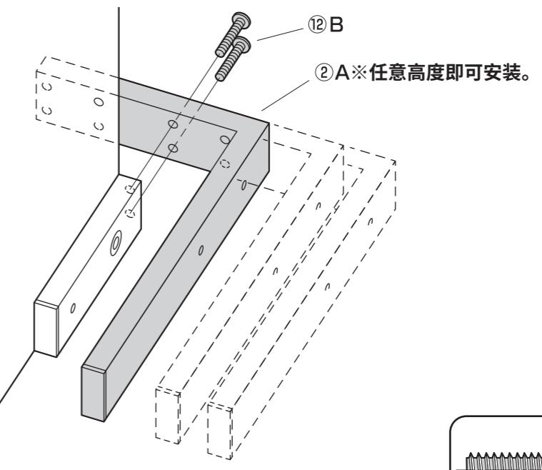
※请在相同高度安装另一侧的脚架。
