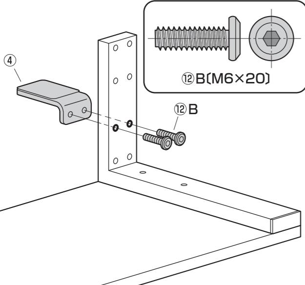
请按相同方法安装另一个L型金属零件。
