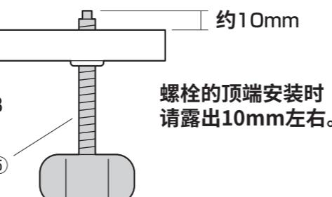
请按相同方法在另一个脚架上安装螺栓。
