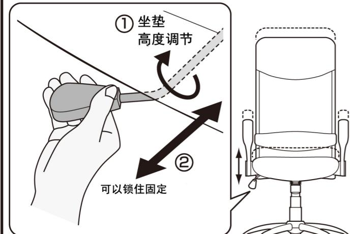
① 将杆按箭头方向旋转可以调节坐垫的高度。
